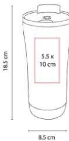
Doble pared. Pared interna plastico, pared externa acero inoxidable. Base de corcho. Tapa en dos posiciones.
