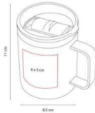
Doble pared. Cerrado al vacío. Pared interna y externa de acero inoxidable. Terminado rugoso.
