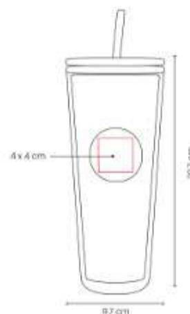
Vaso doble pared. Pared interna y externa de plastico. Tapa de rosca y ranura para popote.
