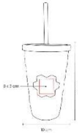
Vaso doble pared. Pared interna y externa de plastico. Tapa de plastico con sistema de rosca. Incluye popote.
