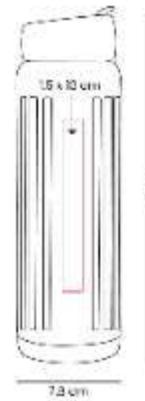
Doble pared. Cerrado al vacío. Pared interna y externa acero inoxidable. Tapa metalica con sistema de rosca.
