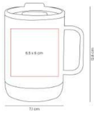
Doble pared. Cerrado al vacío. Pared interna y externa de acero inoxidable. Base texturizada elaborada de corcho y PVC.
