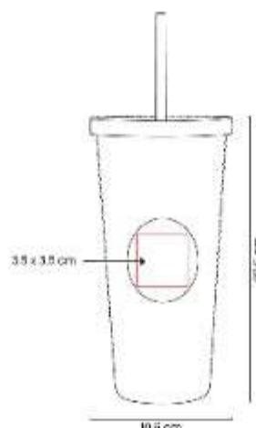
Doble pared. Pared interna y externa de plastico. Tapa de plastico con sistema de rosca. Incluye popote.
