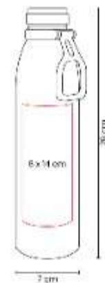
Doble pared. Cerrado al vacío. Pared interna y externa acero inoxidable. Terminado rugoso.
