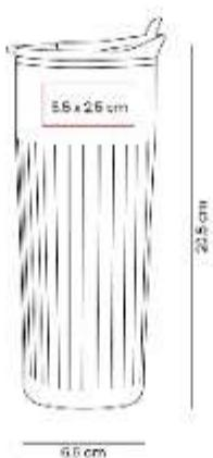
Doble pared. Pared interna de plastico, pared externa de acero inoxidable. Tapa de plastico con sistema de push.
