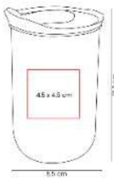
Doble pared. Pared interna de acero inoxidable y externa de plastico.
