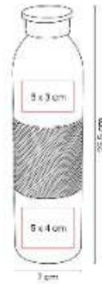
Termo doble pared. Cerrado al vacio. Pared interna y externa acero inoxidable. Tapa de plastico con sistema de rosca.
