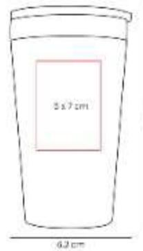
Doble pared. Cerrado al vacío. Pared interna y externa de acero inoxidable. Tapa de plastico con valvula de seguridad.
