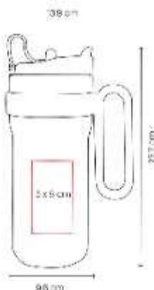
Termo doble pared. Cerrado al vacio. Pared interna y externa de acero inoxidable. Cuerpo con terminado rugoso.
