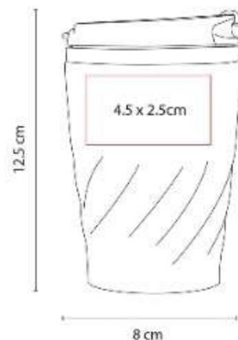
Doble pared. Pared interna plastico, pared exterior acero inoxidable. Tapa de plastico con valvula de seguridad.
