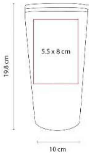
Doble pared. Pared interior plastico, pared exterior acero inoxidable. Tapa de plastico con valvula de seguridad.
