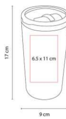
Doble pared. Pared interna plastico, pared externa acero inoxidable. Tapa de plastico con valvula de seguridad.
