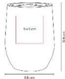
Doble pared. Pared interna de plastico, pared externa de acero inoxidable. Tapa de plastico con valvula de seguridad.
