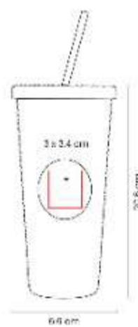
Doble pared. Pared interna y externa de plastico. Tapa de plastico con cierre de rosca.
