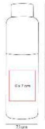
Termo doble pared. Cerrado al vacio. Pared interna y externa acero inoxidable. Tapa metalica con sistema de rosca.
