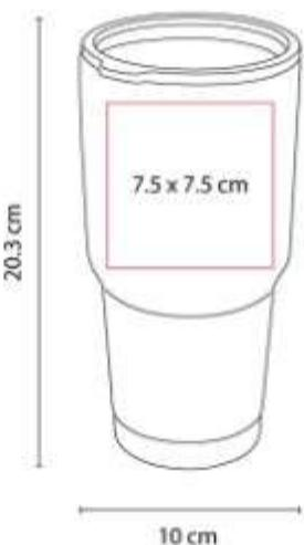
Doble pared. Cerrado al vacío. Pared interna y externa acero inoxidable. Tapa de plastico con valvula de seguridad.
