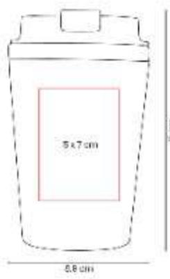
Termo doble pared. Pared interna de acero inoxidable y externa de plastico.
