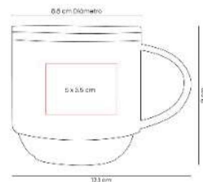
Taza doble pared. Cerrado al vacío. Pared interna y externa de acero inoxidable. Terminado rugoso.
