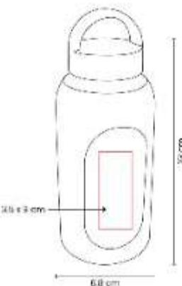
Cilindro de vidrio con manga de silicon graduada en ml. Tapa de plastico con sistema de rosca y asa.
