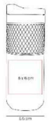
Doble pared. Cerrado al vacío. Pared interna y externa de acero inoxidable.
