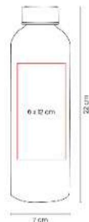
Cilindro de aluminio de una pared. Tapa de plastico con cierre de rosca. Terminado metalico. Incluye caja individual.
