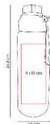
Cilindro de plastico de una pared. Tapa de plastico con sistema de rosca y sobretapa para la boquilla.
