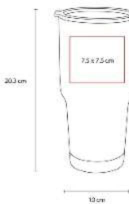
Doble pared. Cerrado al vacío. Pared interna y externa acero inoxidable. Terminado tipo rubber.
