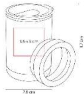
Doble pared. Cerrado al vacío. Pared interna y externa de acero inoxidable.
