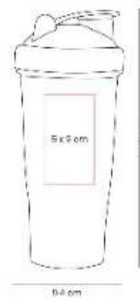
Cilindro shaker con agitador. Tapa de plastico con sistema de rosca que incluye boquilla con sobretapa push.
